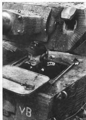
На борту этой «четверки» хорошо видна циммеритовая обмазка
